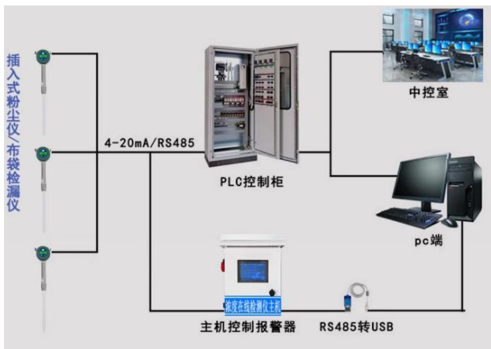
图 5-8 粉尘布袋检漏系统
